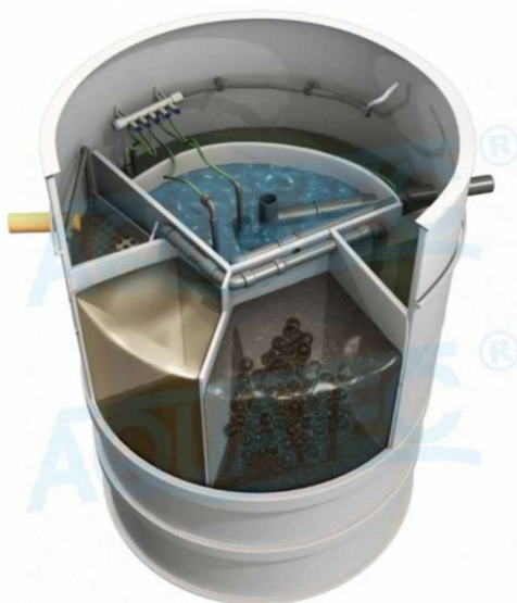
Příklad domovní čistírny odpadních vod
